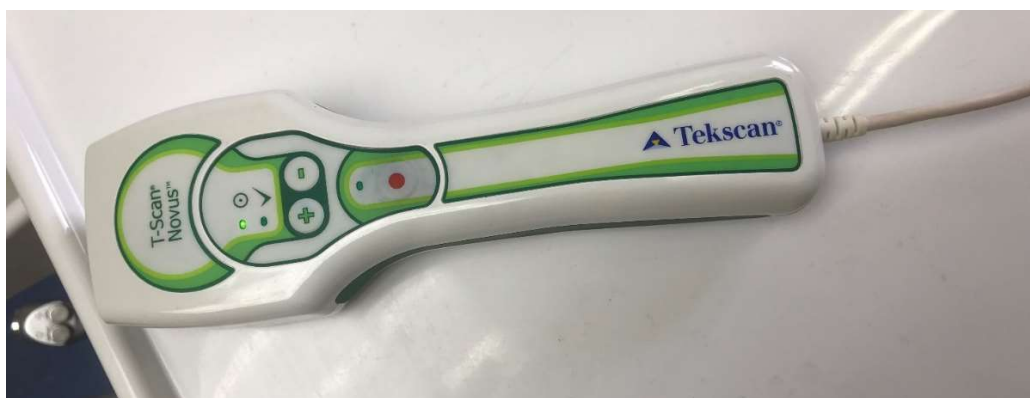
Рис. 2.7. Автоматизований комплекс реєстрації оклюзійних співвідношень T-SCAN Novus (Tekscan)
